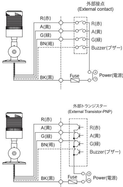
• 電源線/ 信号線規格 - UL1007 AWG22(0.3sq) 400mm
